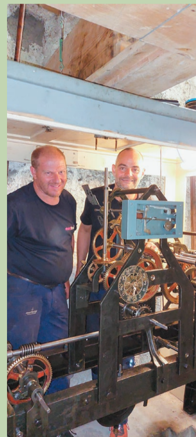
Die revidierte Uhr wird wieder eingebaut von den Mitarbeitern der Muri Baer AG aus Sumiswald, Silvan Fuchs und Oliver Baer.
